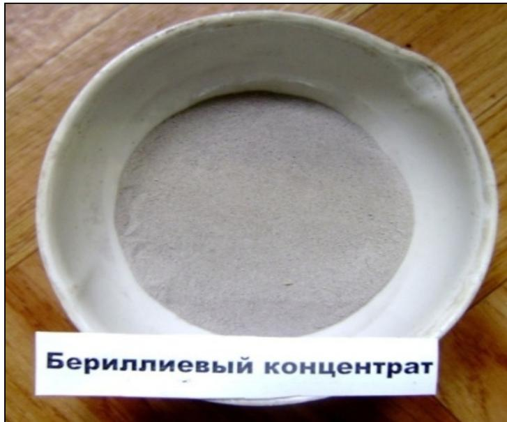
Полученные концентраты пригодны для переработки по *автоклавно-мембранной технологии* с получением гидроксида бериллия, разработанной ВНИИХТом: автоклавное вскрытие; разделение технологической суспензии; очистка растворов от примесей; мембранный электродиализ щелочных растворов; гидролиз бериллата натрия с выделением гидроксида бериллия
