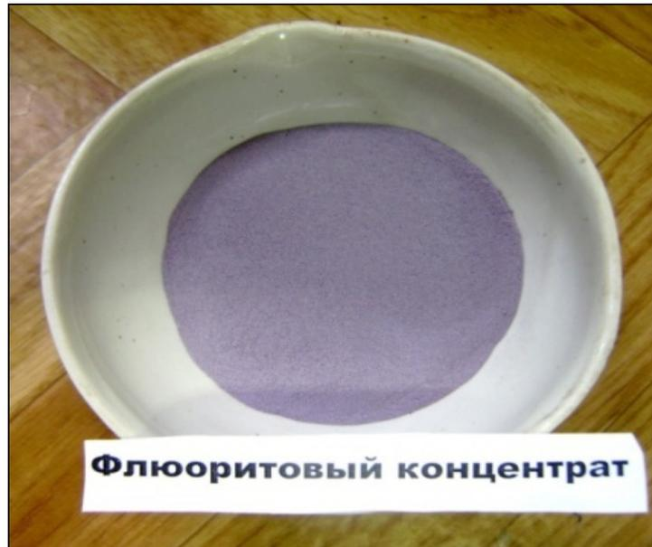
Пригоден для использования в производстве электролитического алюминия, плавиковой кислоты, фтористых солей (в т.ч. особо чистых), безводного фтористого водорода, стеклянных термостойких труб, стеклошариков, стекловолокна и высококачественных силикатных эмалей
