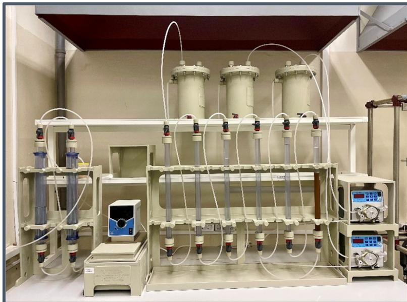
Установка «Сорбция» (ФГБУ «ВИМС»): сорбционный и десорбционный узлы
